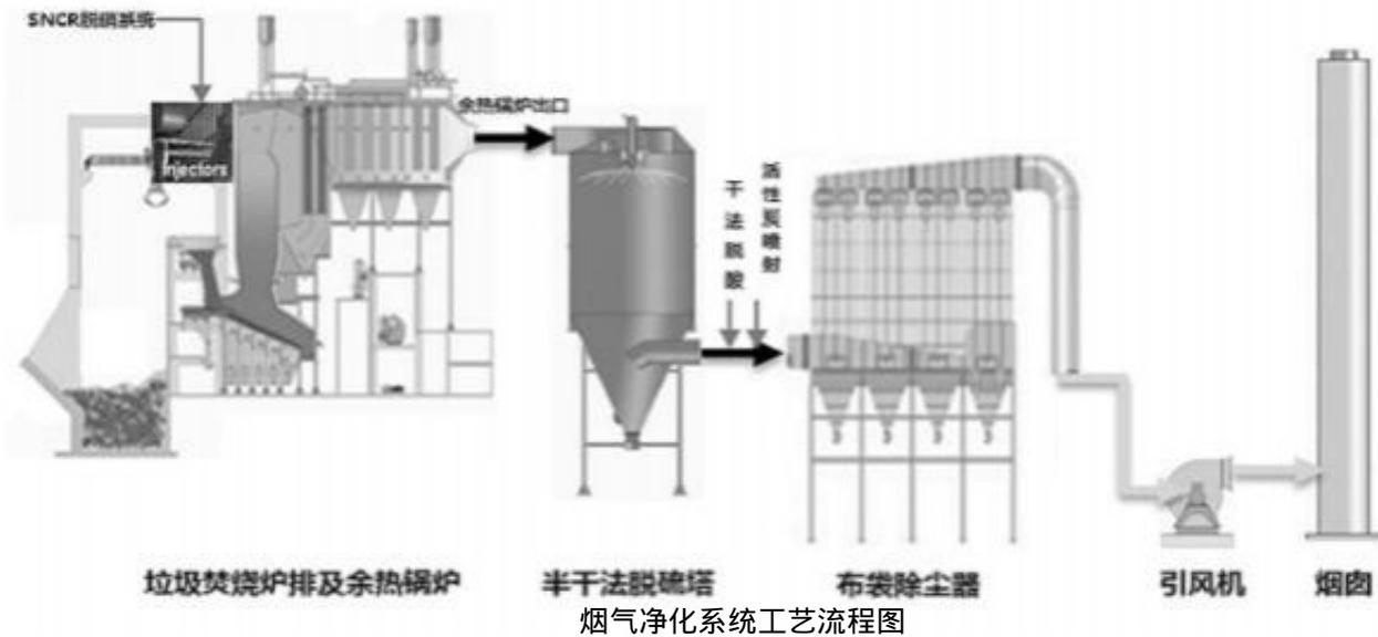
垃圾焚烧烟气净化工艺中，NO<sub>x</sub>的去除在锅炉部位进行。烟气净化系统布置在每台余热锅炉之后，依次是反应塔、布袋除尘器、引风机和烟囱。反应塔和布袋除尘器布置在室内，引风机布置在室外。SNCR脱硝用于脱除烟气中的NO<sub>x</sub>，脱除率为45%~55%。半干法脱酸脱除烟气中HCl、HF、SO<sub>x</sub>等气体。干法脱酸是对半干法脱酸的补充。
