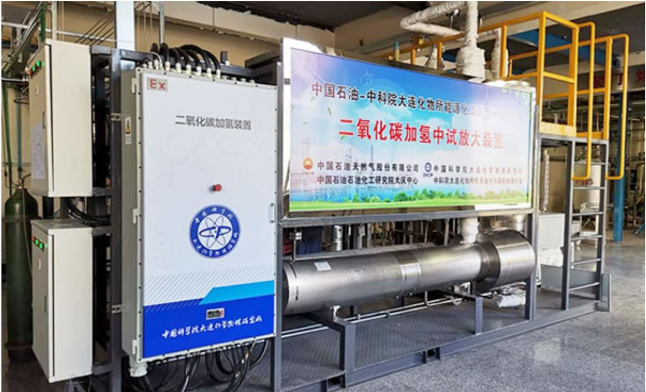
近日，中国科学院大连化学物理研究所催化与新材料研究中心与中石油合作开展的二氧化碳（CO<sub>2</sub>）加氢制甲醇研究取得阶段性成果：中试撬块装置在中石油大庆化工研究中心一次开车成功，单程CO<sub>2</sub>
