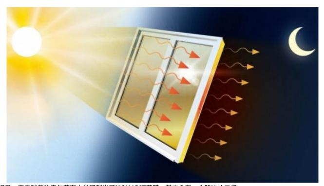
据悉,来自瑞典的查尔莫斯大学研制出了这种MOST薄膜,其中含有一个降冰片二烯-四环庚烷分子(norbornadiene – quadricyclane molecule)。这使得透明的聚合物薄膜在没有直接暴露在阳光下时呈现出橙黄色。
