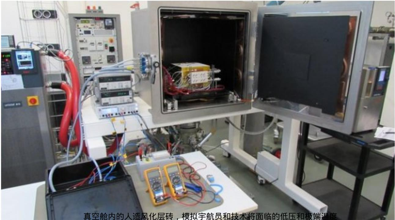
真空舱内的人造风化层砖，模拟宇航员和技术将面临的低压和极端温度
