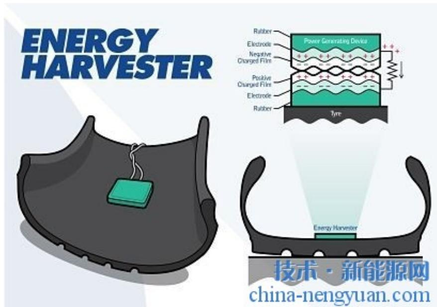
日本福尔肯公司(Falken)正在开发一种新技术，可以在驾驶时利用轮胎发电。福尔肯的母公司住友橡胶工业公司(Sumitomo Rubber Industries)与关西大学(Kansai University)教授谷浩史(Hiroshi Tani)共同开发了一种能量收割机(Energy Harvester)，它利用静电(即摩擦充电)的积累，在轮胎转弯时高效地发电。
