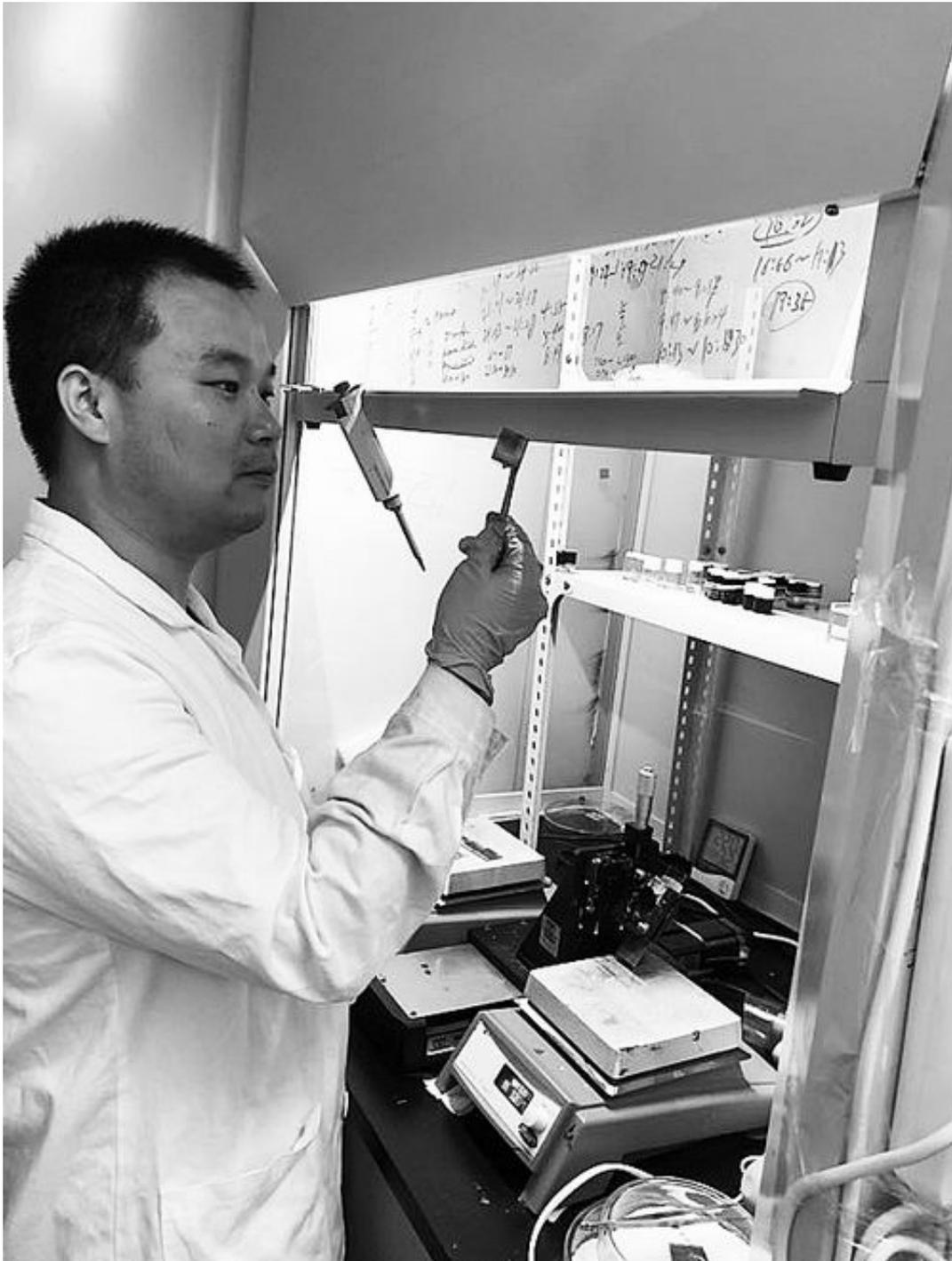
赵奎正在进行空气中刮涂制备钙钛矿薄膜实验。项目组供图
