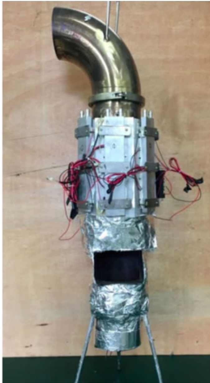
图 1 基于生物质燃料的温差发电机样机
