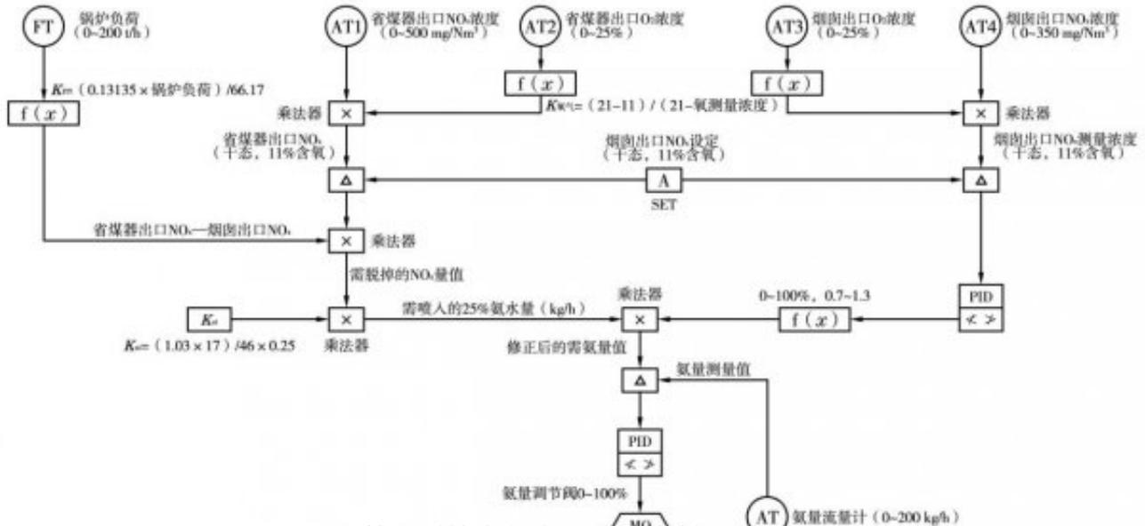
图2 某垃圾焚烧烟气处理SCR脱硝喷氨自动SAMA
