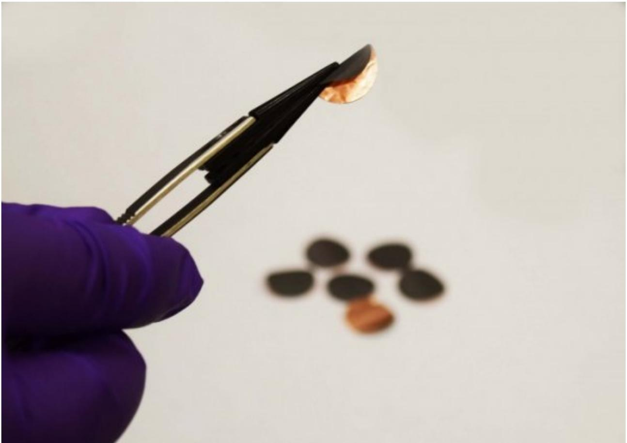
研究人员研发了一种新的网状结构，称为铈纳米链。铈是一种类金属，可增强电池中锂离子容量。科学家将铈纳米链电极与石墨电极进行了比较，结果发现采用铈纳米链电极，硬币大小的电池充电仅耗时30分钟，同时锂离子容量增加了一倍，进行了100次充放电循环。
