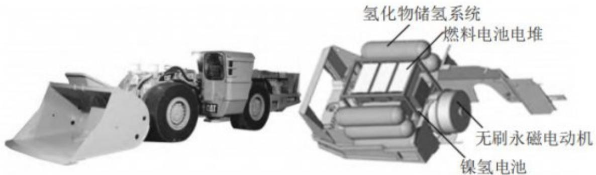
图3 燃料电池矿山装载机及其动力系统示意图
