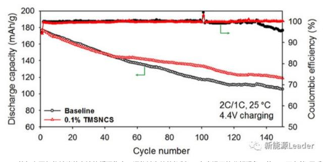
TMSNCS的加入不仅能够改善电池的循环稳定,还能够有效的抑制FEC在高温下的分解现象,从60 下存储5天后电解液颜色的变化可以看到,TMSNCS的加入显著的抑制了FEC的分解,这主要是因为PF5会催化FEC发生开环反应,产生HF等产物,进而破坏负极表面膜(SEI)和正极表面膜(CEI),而TMSNCS加入后会与PF5,从而提升了FEC的稳定性。TMSNCS的这一作用也体现在电池的45 高温循环中(下图c)。
