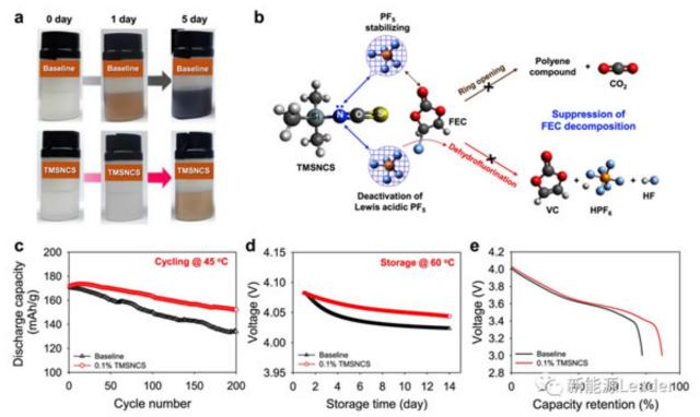
TMSNCS能够捕获电解液中的HF、PF5等有害杂质结合,从而避免HF对正负极界面膜的侵蚀,同时TMSNCS与PF5结合后能够显著提升PF5的稳定性,避免其进一步分解产生高活性的POF3,减少HF的产生,同时TMSNCS与PF5结合后还能抑制PF5对于FEC的催化,从而显著提升电解液的热稳定性,改善电池的循环性能。
