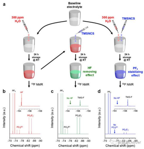
为了测试TMSNCS添加剂捕获电解液中的HF、PF5的能力,作者尝试向电解液中分别添加或者同时添加TMSNCS和300ppm的水分,然后对F元素进行核磁共振分析。从上图b的分析结果可以看到,对照组电解液出现了三个成对的特征峰,在-72和-73ppm处对应的为PF6-,在-75和-83ppm处对应的为PO3F2-和PO2F2-,这两种分解产物主要是由LiPF6在水分的作用下分解产生的,同时我们在-154.4ppm处观察到了HF的特征峰,HF产生的反应机理如下式所示。
