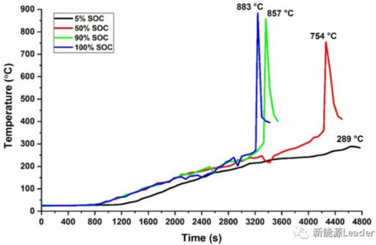
在下图中作者对不同SoC电池在热滥用测试中的热失控起始温度和最高温度进行了线性拟合，从拟合结果可以看到随着电池SoC的升高，电池热失控的起始温度出现了线性的降低，热失控中达到了最高温度则随着SoC的升高而增加，表明较高的SoC会导致锂离子电池的热稳定性显著降低。
