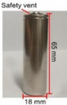
试验中采用的锂离子电池为18650电池，电池的基本信息如上表所示，电池的正极为NCM111材料，负极为石墨材料，额定容量2400mAh，分别测试该电池在5%、50%、90%和100%SoC状态下的热稳定性。
