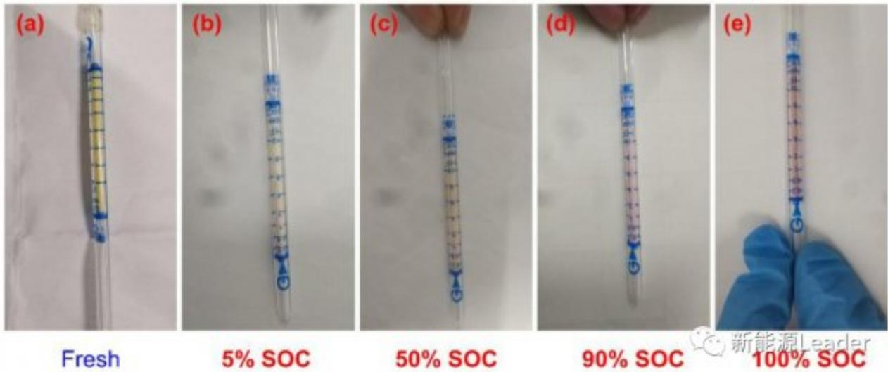
Zhenghai Liao的研究表明电池的SoC状态对于锂离子电池热稳定性具有显著的影响，SoC状态越高电池热失控的触发温度越低，热失控的最高温度越高。同时SoC也会对电池产生的气体的种类产生显著的影响，在较高的SoC下会产生跟多种类的气体，同时气体中也含有更多有毒的HF气体。
