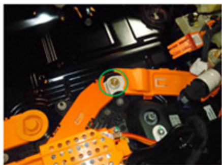
图 3-59 正极 Busbar 与主正继电器 busbar 的连接
