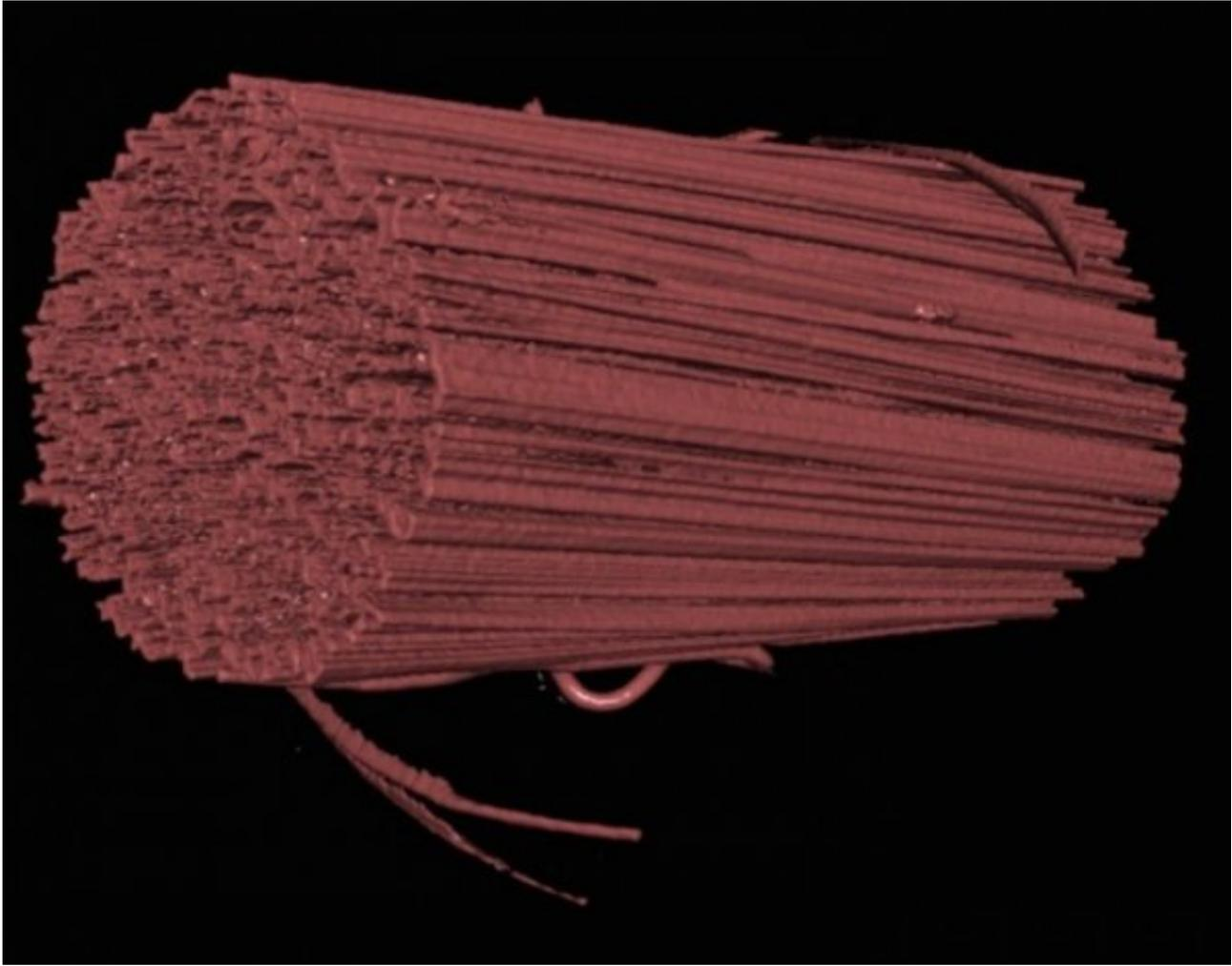
结果是单根纤维由许多连接的原纤维组成。拉伸并加热该纤维，然后将其冷却几个小时-仍处于拉伸状态。据说成品具有与蜘蛛丝相似的品质。一根短短的纤维（重量小于“果蝇”）可用于反复提起30克重量的物质，而不会折断或永久拉伸。现在研究人员希望，一旦技术进一步发展，“多纤维聚丙烯腈纤维”就可以在纺织、航空航天或医药等领域得到应用。
