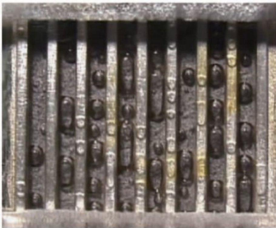
图1 \mu\text{DMFC} 阳极流道内气泡行为 [14]
