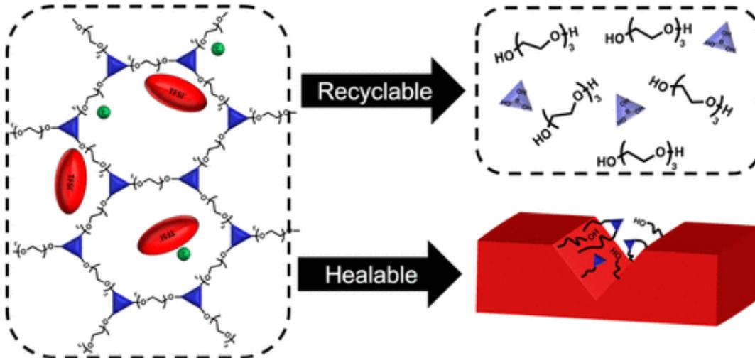
UI团队开发了一种制作交联键的方法，以便它们产生交换反应，并在它们之间交换聚合物链。这意味着聚合物在加热时会变硬，并且会自我修复，导致树枝状晶锂枝晶的生长减少。此外，无需强酸或高温即可分解聚合物。相反，它在室温下溶于水。但是，该技术尚不实用。
