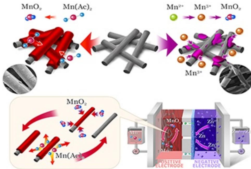
近日，中国科学院大连化学物理研究所储能技术研究部（DNL17）研究员李先锋、张华民团队开发出一种基于双电子转移、沉积-溶解型反应的锰基正极电对，并将上述电对应用于中性锌锰液流电池当中，大幅提高了电池的可靠性。该工作为开发新一代二次锰基电池提供了新思路。
