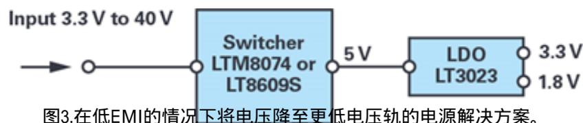
LTM8074是采用小型4mm×4mm尺寸BGA封装的SilentSwitcher、Module降压稳压器,能够以低辐射噪声提供高达1.2A电流。SilentSwitcher技术可以抵消开关电流产生的杂散场,由此减少传导和辐射噪声。此Module设备效率高且具
