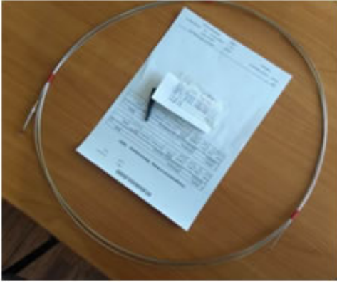
图镀铜光纤外加不锈钢保护套
