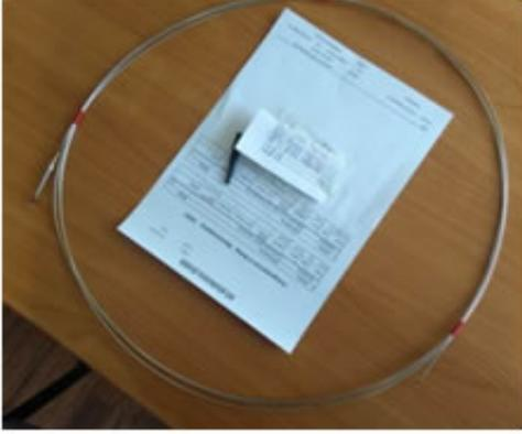
图镀铜光纤外加不锈钢保护套
