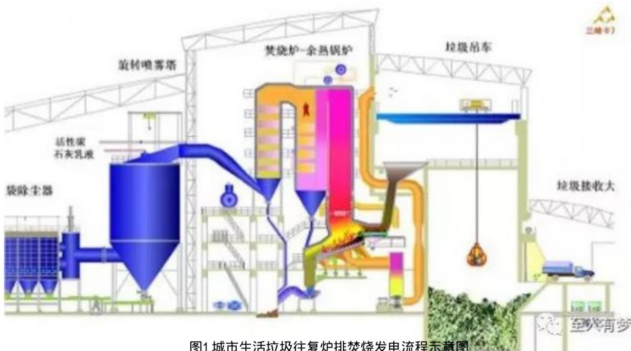
图1 城市生活垃圾往复式炉排焚烧发电流程示意图
