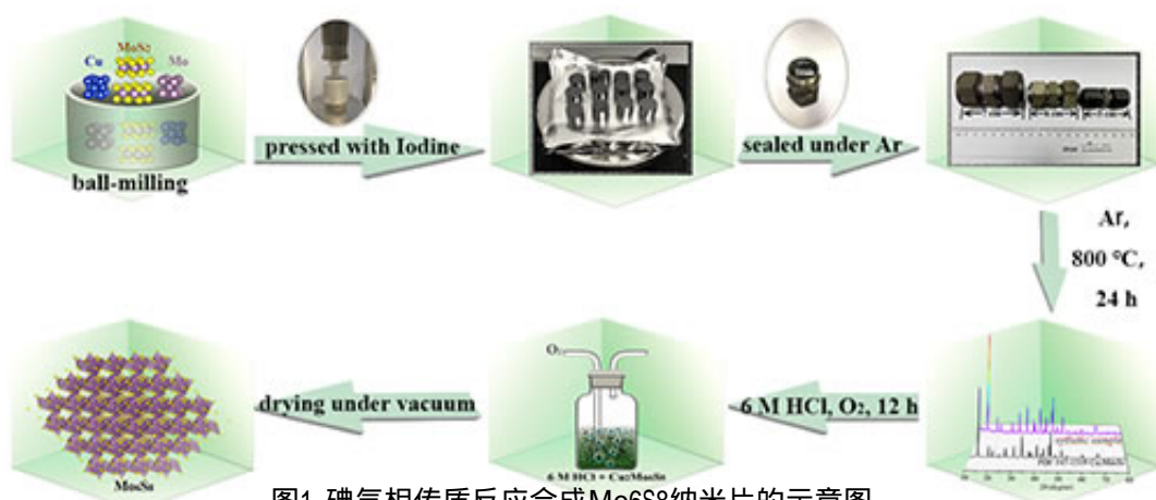
图1. 碘气相传质反应合成Mo 6 S 8 纳米片的示意图。
