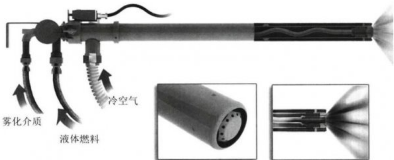
图 11 典型空气雾化燃油喷枪结构示意图
