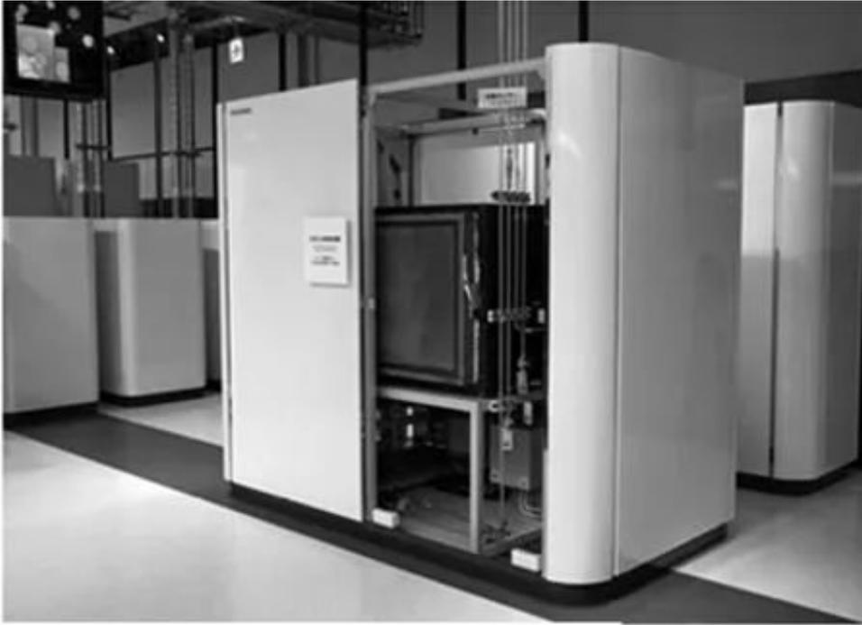
图 5. SOEC 多重电池堆评测装置：位于氢能源研究开发中心，能对 10kW 以上规模的 SOEC 的特性进行评测
