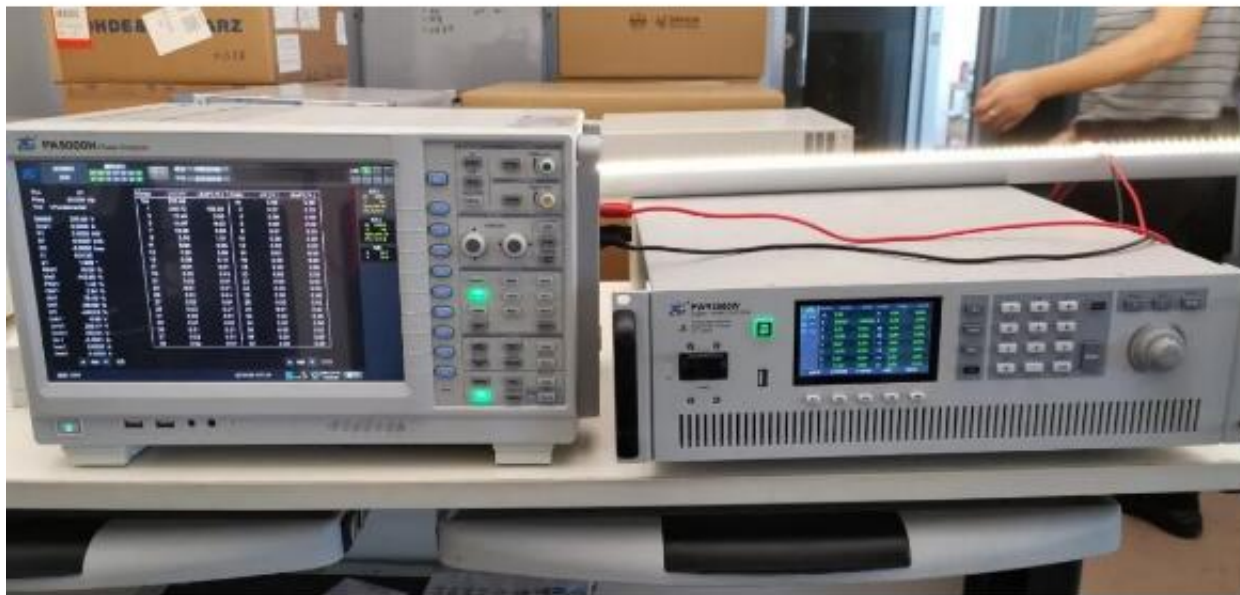
图2 LED灯具电网谐波抗扰度测试
