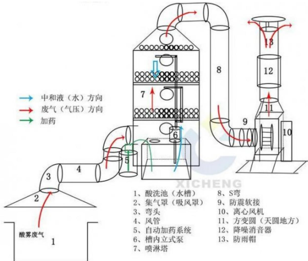
该酸雾喷淋塔是圆形塔体，主体结构为“两层喷淋一层除雾”，塔内右下往上，废气经过两级喷淋层一级除雾层。喷淋层和除雾层合理优化，填料采用高效、低阻的拉西环和多面球，使废气与氢氧化钠吸收液进行气液两相充分接触吸收中和反应。升级除雾装置，采用板式收水器作为除雾层支撑托板，有效分离气液，提高废气净化效率。塔体可根据实际情况采用PP阻燃材质或者PPS阻燃材质制作，同时塔体进行了技术参数上的优化，结构简单、能耗低、净化效率高；酸雾净化塔它具有效力高、耐腐蚀性强，高强度、低噪声、耗电省，拆装维修方便；适用范围广，可同时净化多种污染物，压降较低，操作弹性大，且具有很好的除雾性能，适合于连续和间歇排放废气的治理。工艺简单，管理、操作及维修相当方便简洁，不会对车间的生产活动造成任何影响。
