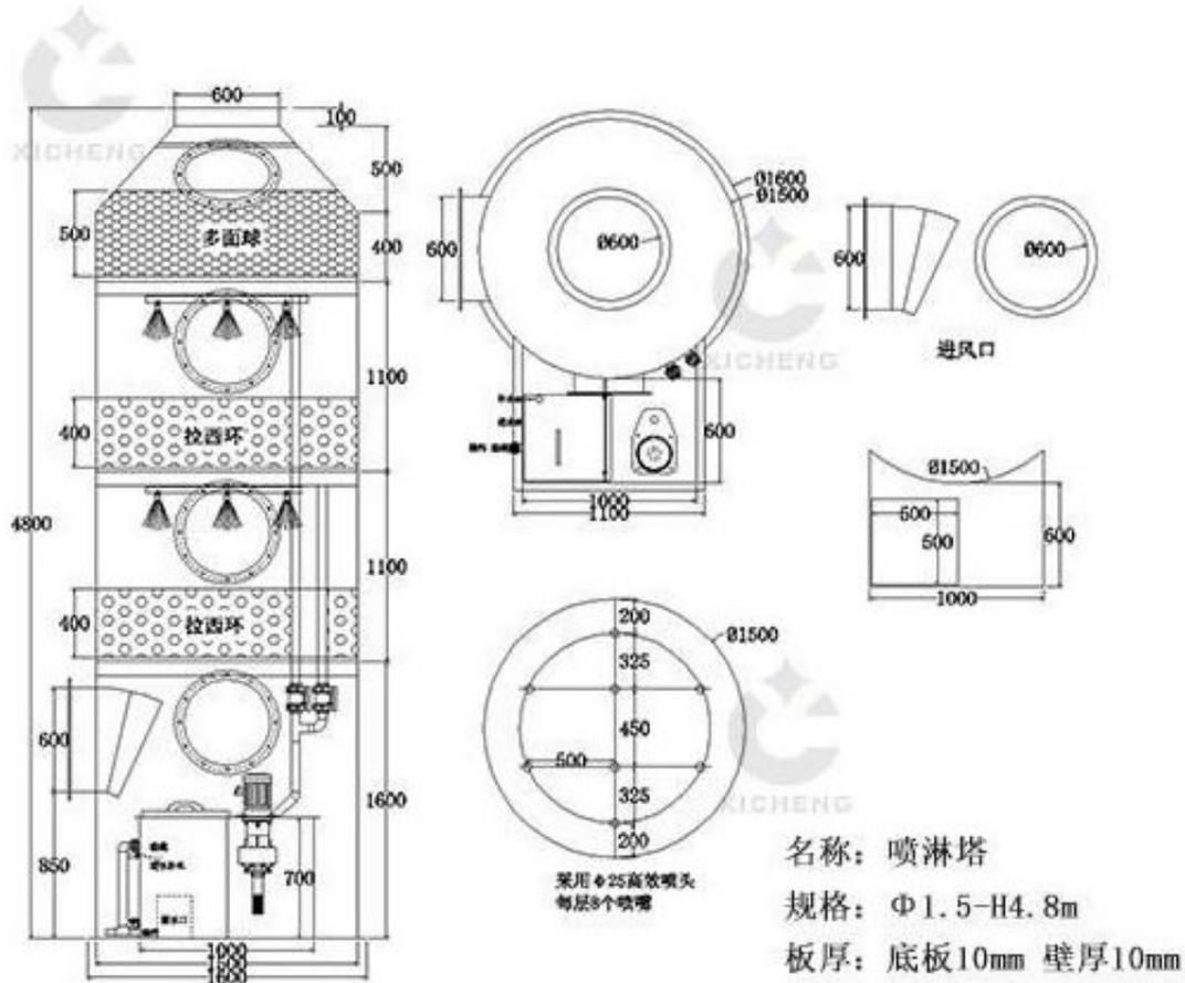
目前，喷淋塔用于酸雾废气净化处理是比较经济实用、高效节能的，经过喷淋塔净化处理后排放的气体符合“大气污染物综合排放标准(GB16297-1996)”。喷淋塔采用环保材料PP阻燃材质和PPS阻燃材质制作，故而又称PP阻燃喷淋塔和PPS阻燃喷淋塔，具备阻燃防火的特性。我公司自主开发了净化效率高、操作管理简单、使用寿命长适用于酸、碱性废气净化处理的喷淋塔。
