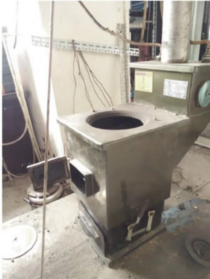
图 1 炊事-采暖型燃煤炉具
