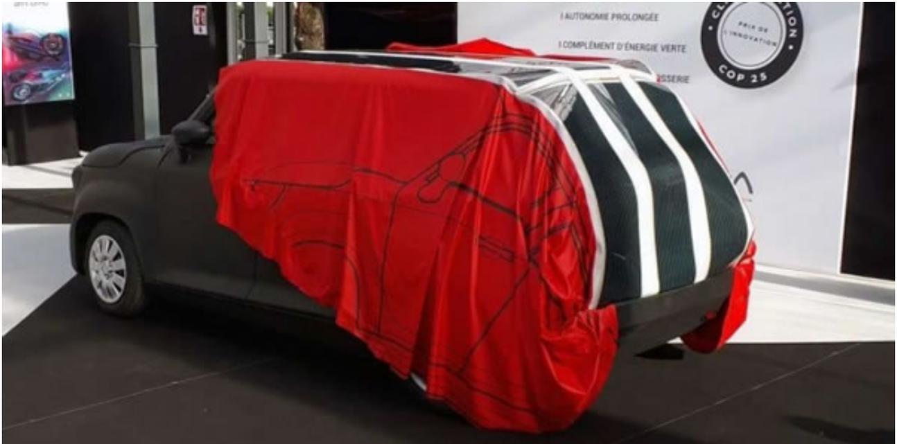
车盖本身是一块防水布，使用Armor ASCA有机光伏膜组件。该技术基于半导体有机聚合物，其形式是通过在柔性薄膜上的涂层工艺沉积薄层。Armor表示，这种柔性太阳能板可以在发生损耗之前能折叠的次数至少能达5万次。
