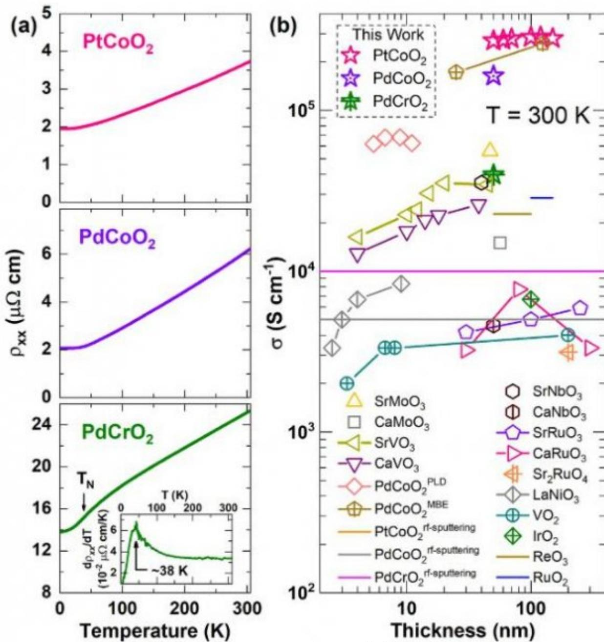
图2. PtCoO<sub>2</sub>、PdCoO<sub>2</sub>和PdCrO<sub>2</sub>薄膜电输运性能。
