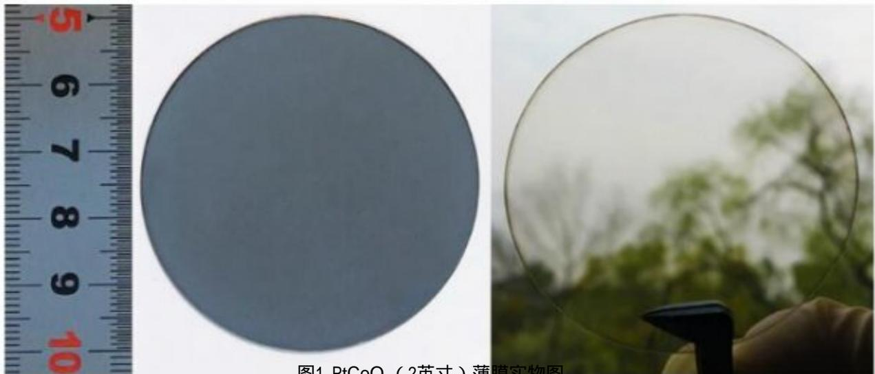
图1. PtCoO<sub>2</sub>（2英寸）薄膜实物图。
