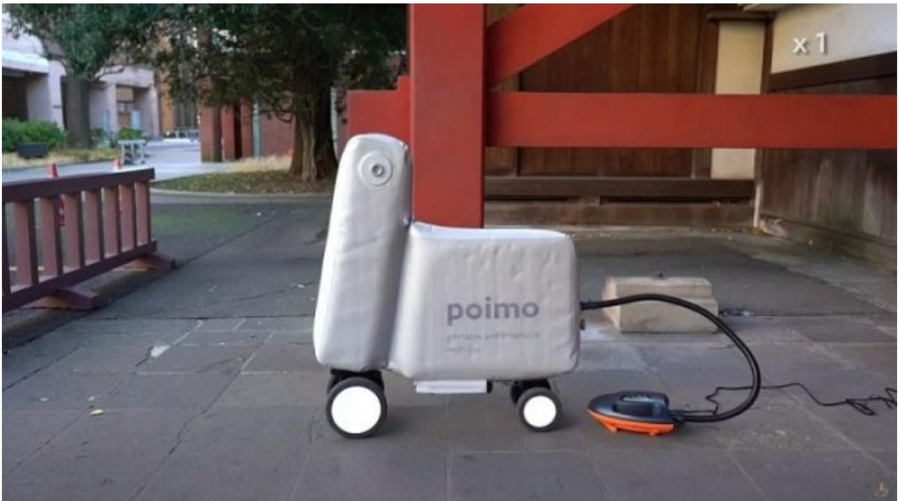
目前这款电动自行车还处于原型阶段，所以实际设置起来可能要比视频中展示的要更麻烦一些。车轮和车把手都是可拆卸的而且这个原型版本似乎还需要一个外置的空气压缩机来把它泵起来，以承受骑行者的重量。一旦充好气并组装起来，那么你就可以带着它出发了。
