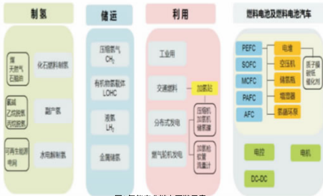
图1 氢能产业链上下游示意
