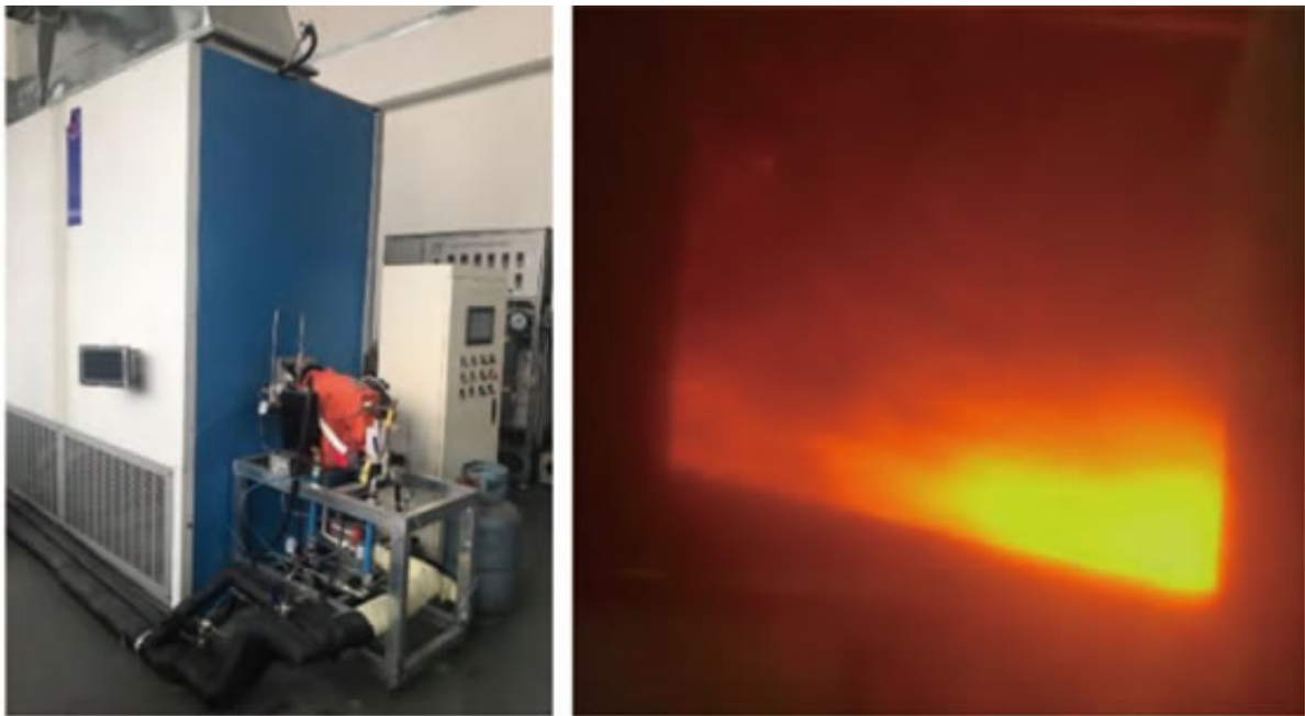
图6 热解焦油燃烧试验平台现场
