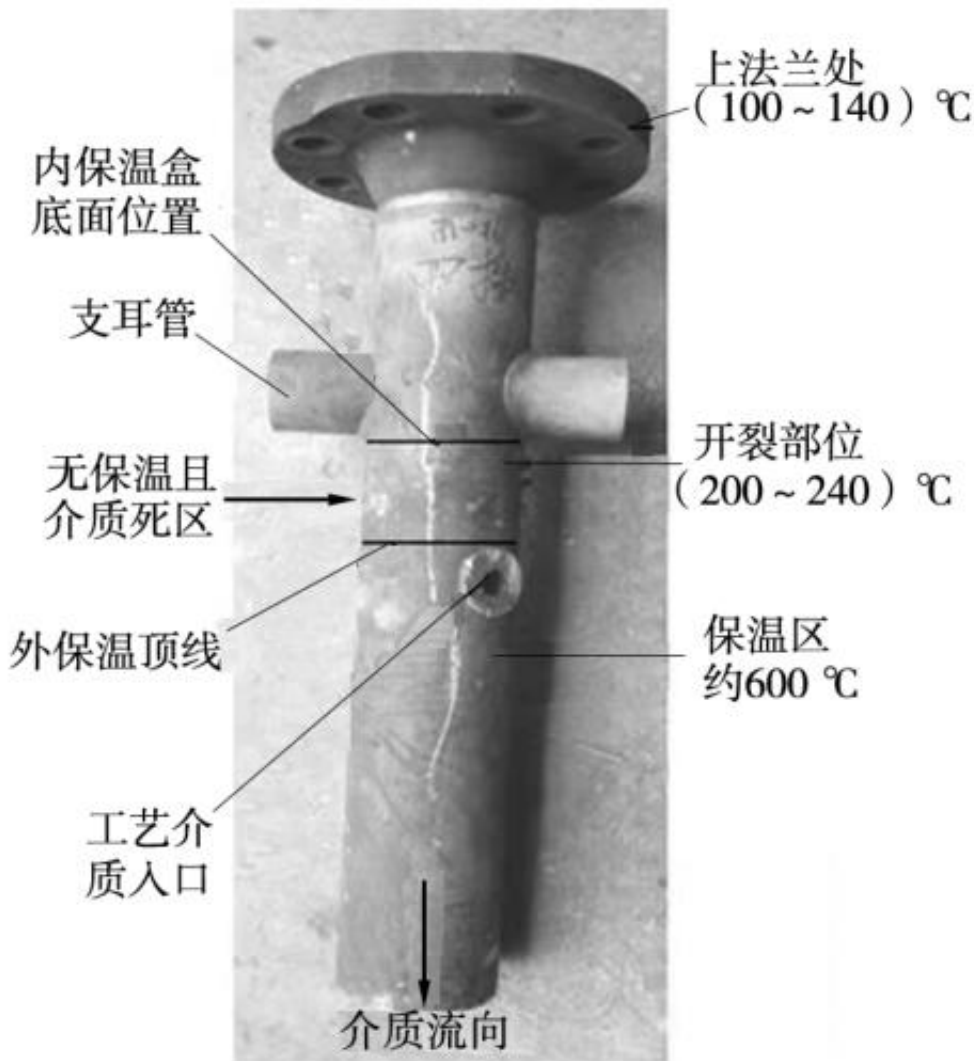
图 8 炉管开裂区域裂纹成因分析
