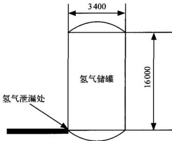
图2 氢气储罐容器破裂泄漏示意图
