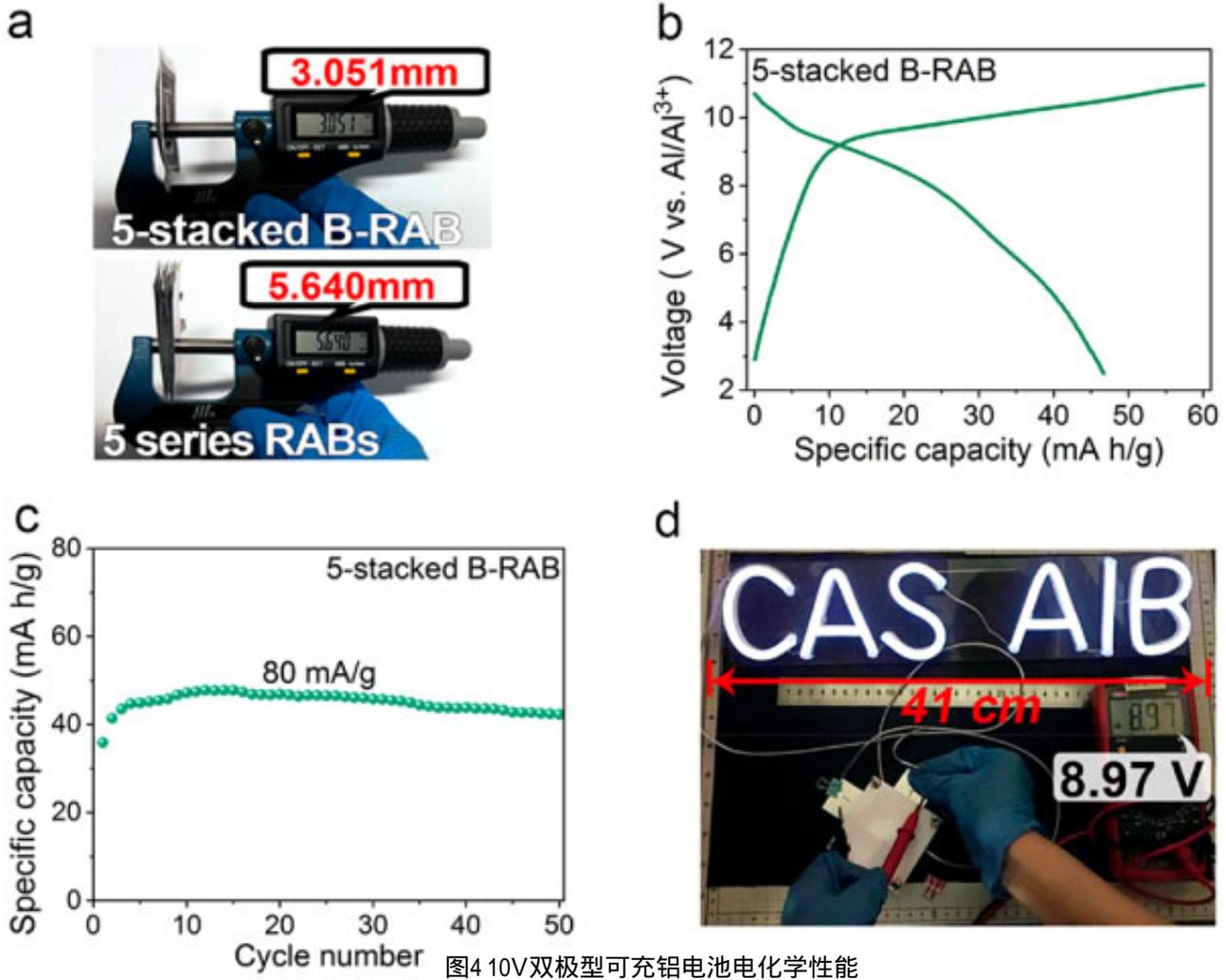
图4 10V双极型可充铝电池电化学性能
