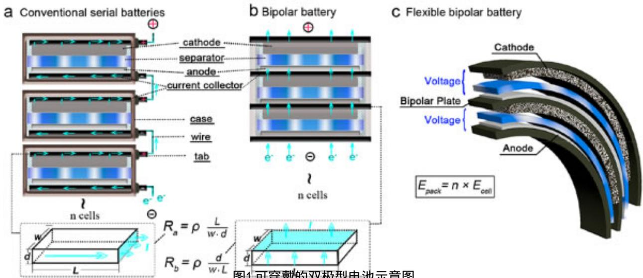
图1 可穿戴的双极型电池示意图
