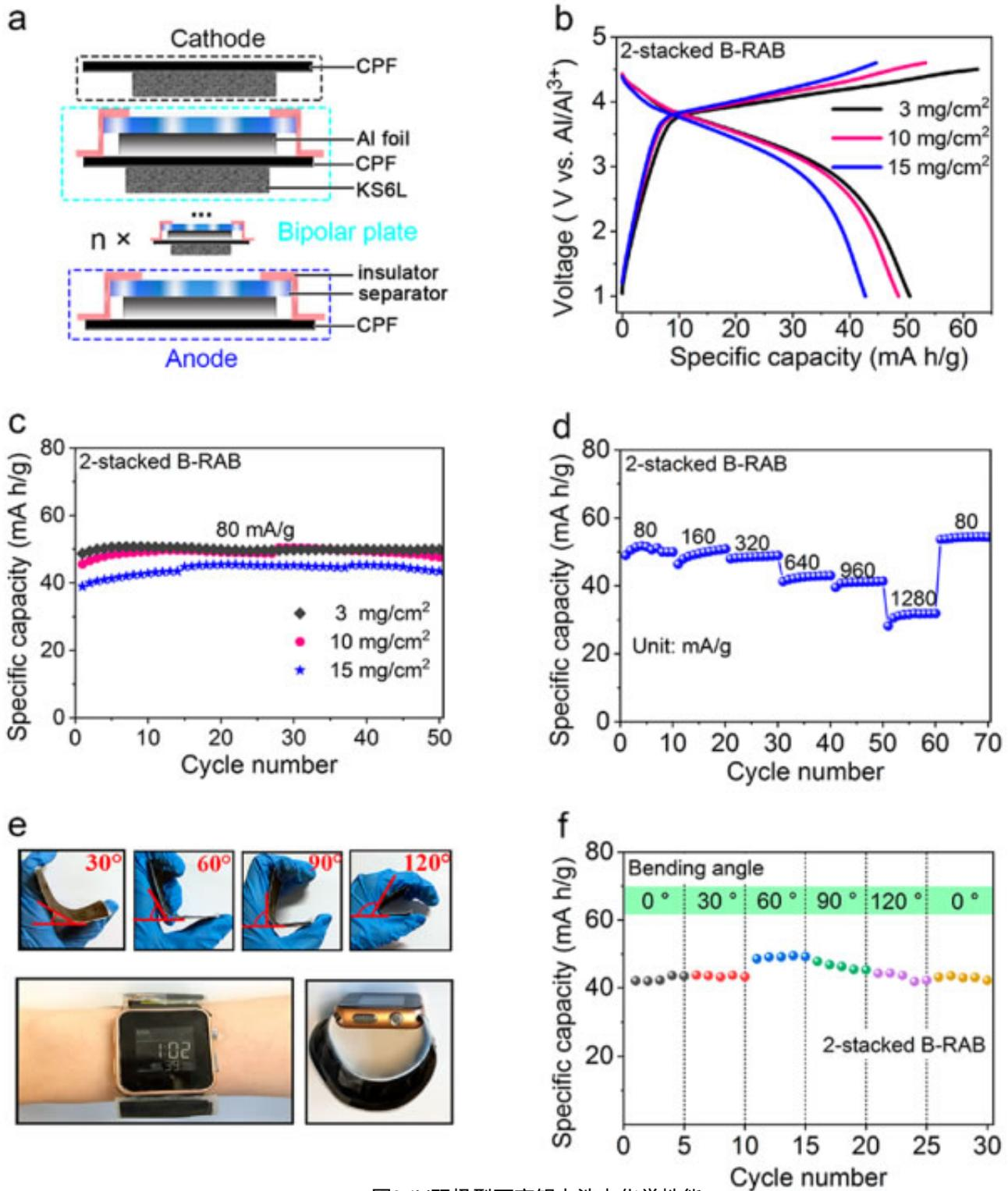
图3 4V双极型可充铝电池电化学性能
