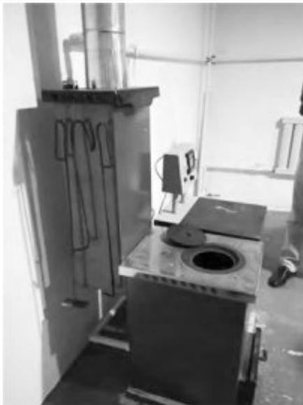
(a) 4kW 生物质燃烧炉
