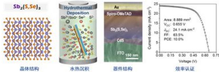
鉴于 $Sb_2(S,Se)_3$ 具有良好的稳定性和丰富元素储量，光电转换效率的进一步提升有望推进应用。本文发展的水热沉积法在超临界的状态下水热沉积过可以生成致密、平整且横向元素分布均匀的光吸收薄膜，从而有利于载流子的传输，结合光吸收、阴阳离子比例的调控以及点缺陷的控制，最终实现了光电转换效率的突破。从材料制备的角度来看，本文发展的水热沉积法是一种简便、低成本的薄膜制备方法。
