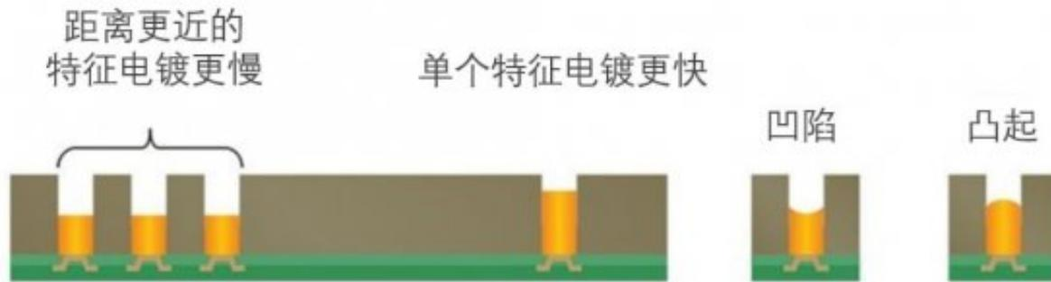
图2. 电镀大型铜柱的常见差异包括电流负载问题、凹陷和凸起。
