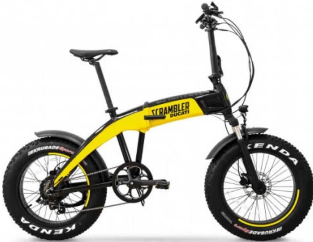
接下来，以Ducati Scrambler品牌销售的是SCR-E。其拥有同样的20 × 4轮胎和悬挂叉，并还配有一个座椅后集成的LED尾灯--由LCD显示屏上的“暮光传感器”自动触发。据报道，给自行车的集成374.4Wh电池充一次电就可以让电动自行车的骑行续航里程达到70公里。
