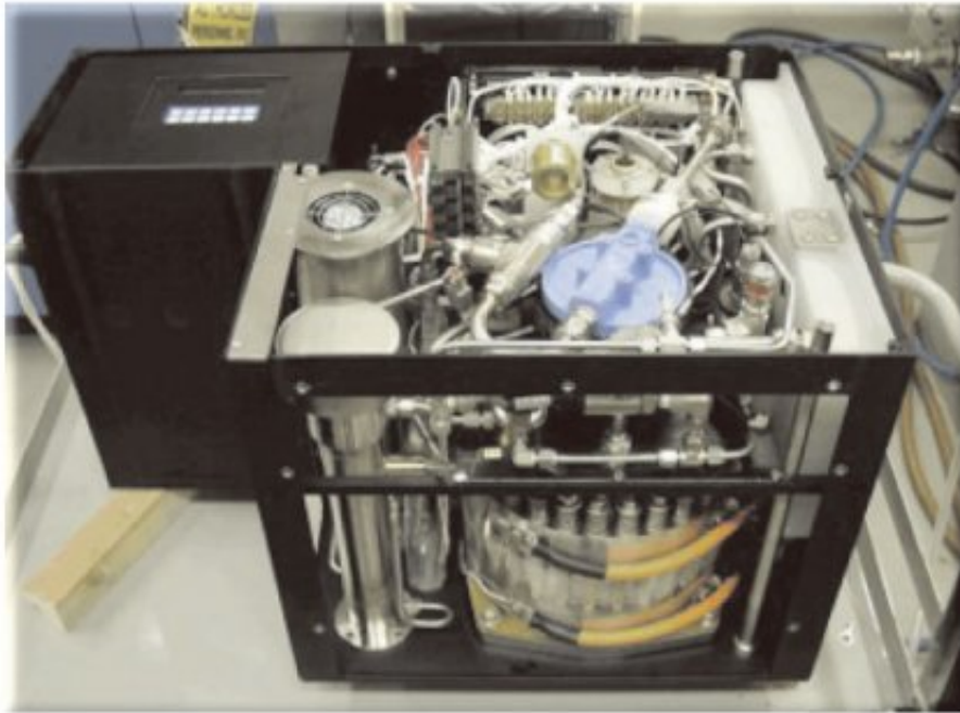
图 3 PEM Treadwell 公司的 PEM 水电解系统
