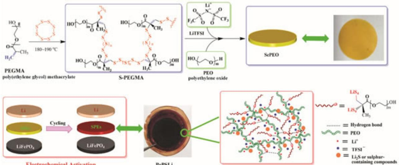
图1 多硫化锂接枝的固态电解质的制备过程
