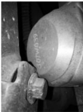
图 4 底盘部件与制动器接触
