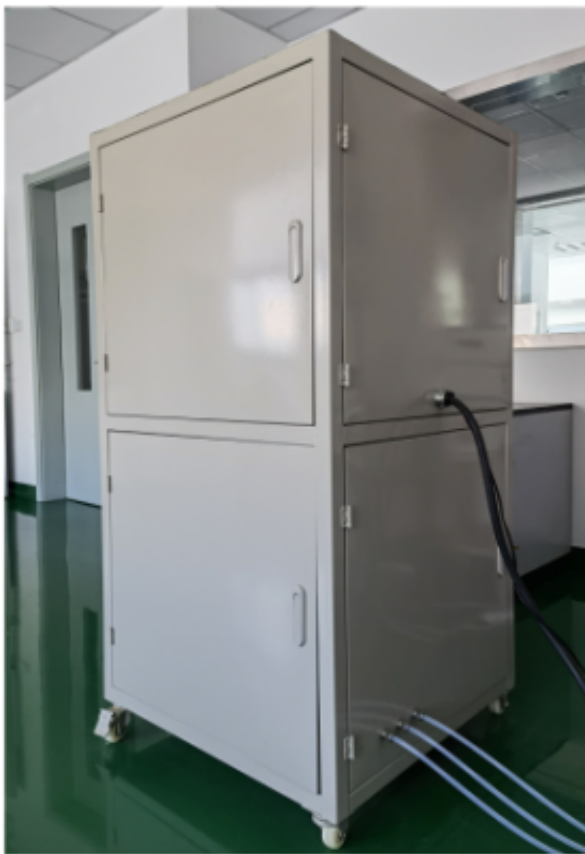
图2.集成的kW级电解制氢样机及模块运行稳定性结果
