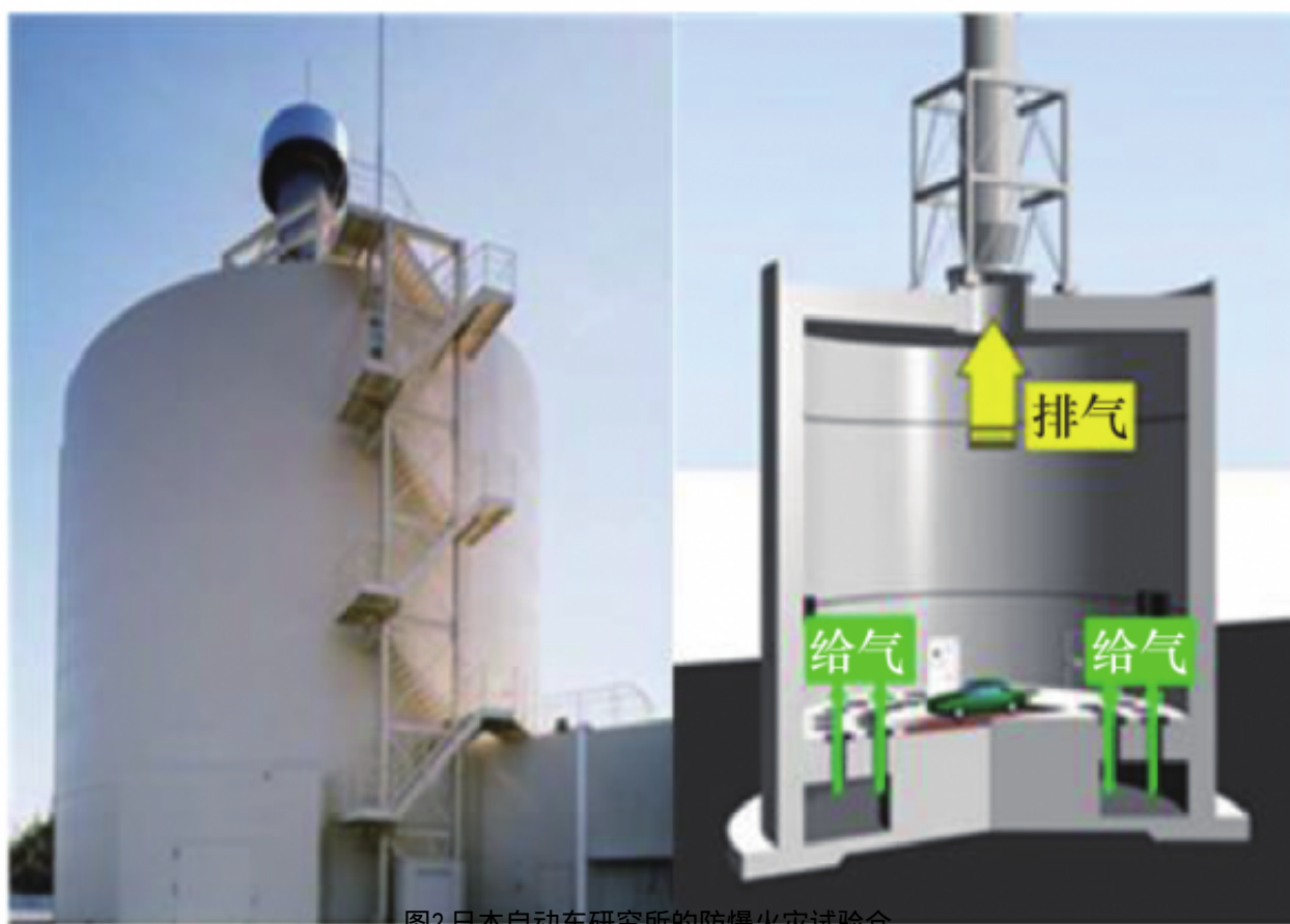
图2 日本自动车研究所的防爆火灾试验仓
