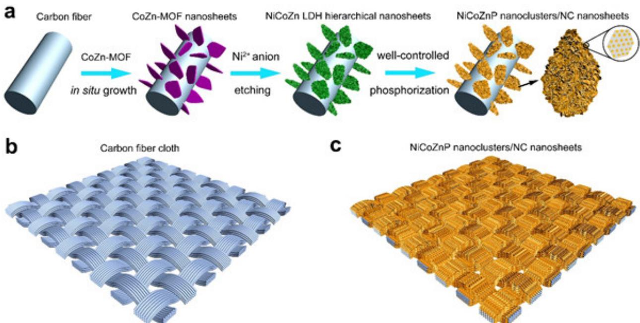
催化剂示意图。a：磷化物纳米晶@氮掺杂碳（NiCoZnP@NC）分级纳米片阵列制备流程示意图，b：碳纤维布电极示意图，c：NiCoZnP@NC分级纳米片阵列示意图
