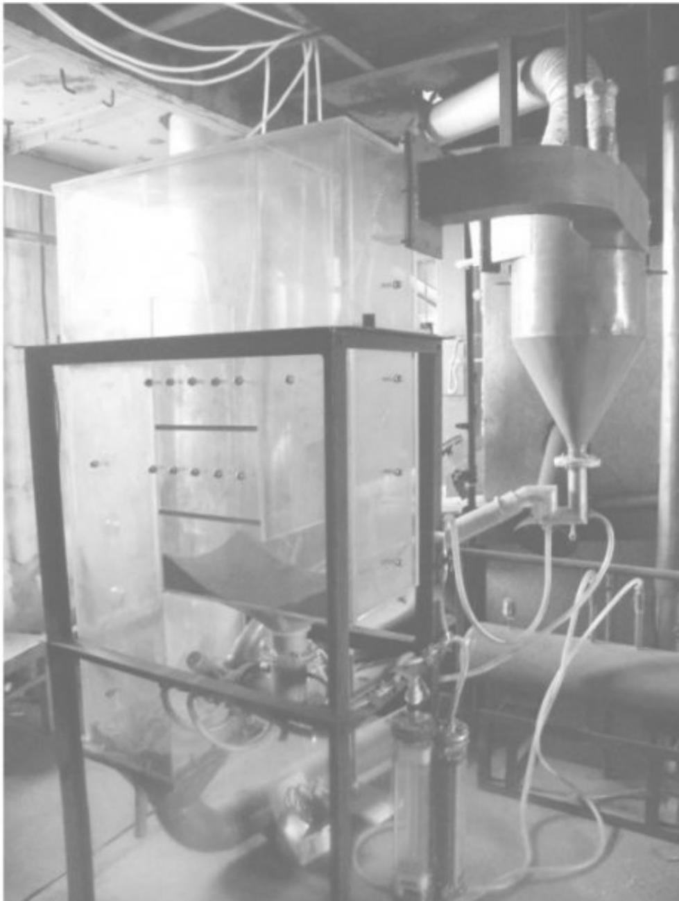
图3 多流程循环流化床冷态实验装置 [22-25]
