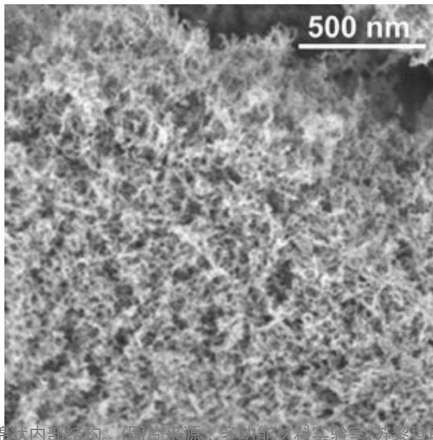
气凝胶的海绵状内部结构。(图片来源：多功能材料实验室/苏黎世联邦理工学院)
