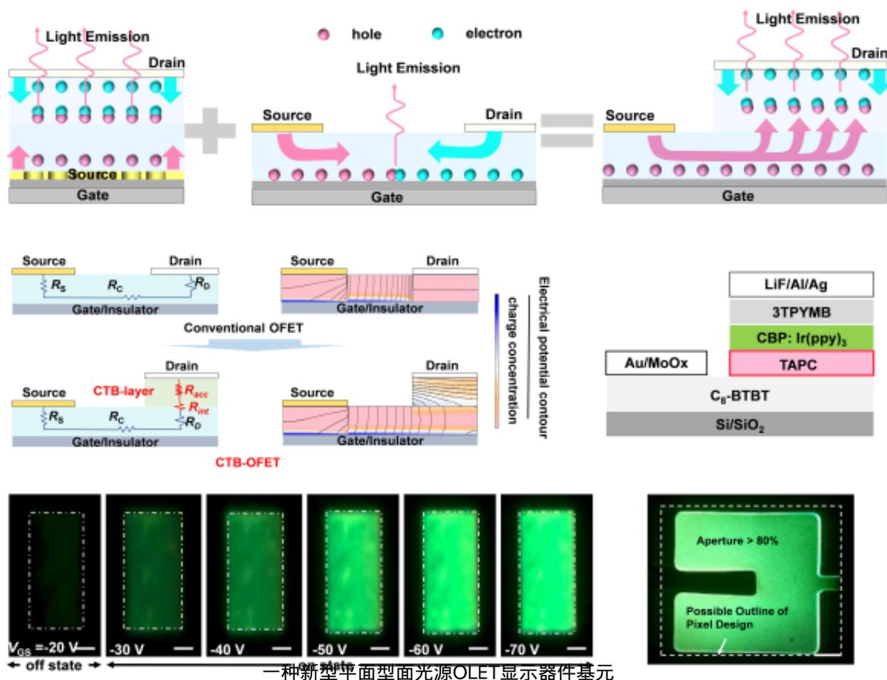
一种新型平面型面光源OLET显示器件单元
