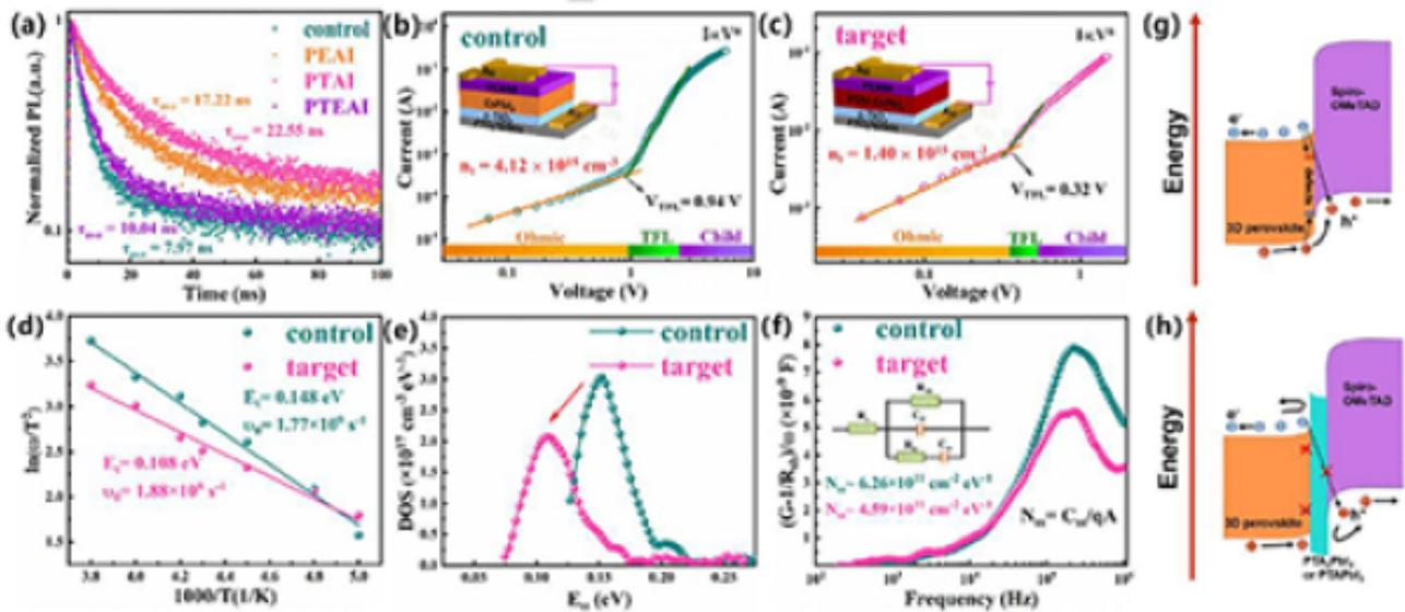
图2.太阳能电池性能表征：(a) 基于不同有机阳离子所制备CsPbI<sub>3</sub>薄膜的瞬态荧光光谱（TRPL）；暗态空间电荷限制电流（SCLC）：(b) 对比组和 (c) 实验组；基于导纳光谱推出 (d) 阿伦尼乌斯关系，用于计算缺陷能级和特征转换频率，(e) 缺陷态密度分布，(f) 界面缺陷；CsPbI<sub>3</sub>/spiro-OMeTAD界面复合的示意图：(g) 对比组和 (h) 实验组。
