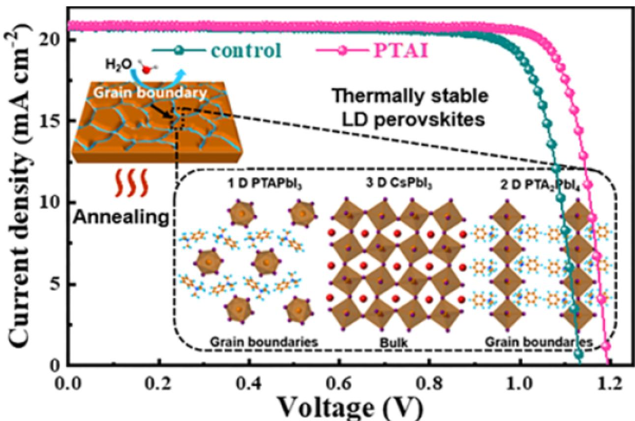
图1.基于PTAI低维钙钛矿钝化策略所制备的CsPbI<sub>3</sub>钙钛矿电池的J-V特性曲线及低维钙钛矿在CsPbI<sub>3</sub>晶界处分布示意图
