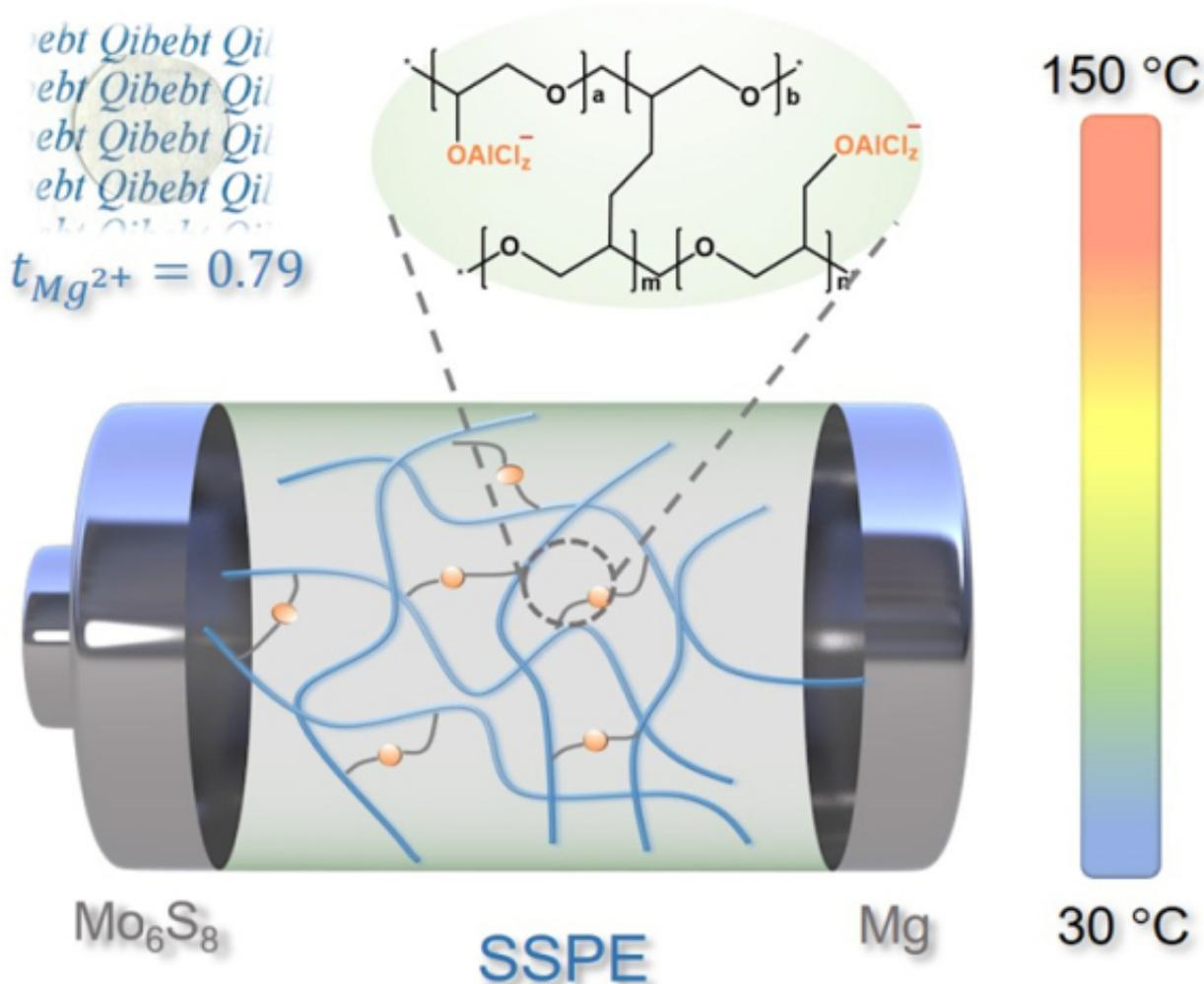
随着对太空和地下资源开发需求的日益增长，人们迫切需要开发出可以耐高温（>100 °C）的特种电源。然而，目前商业化的锂离子电池通常在工作温度超过80 °C时就会出现显著的性能下降，甚至会发生热失控和爆炸，造成严重的安全事故。镁金属因具有化学稳定性好、熔点高（651 °C）和不易生长枝晶等特点而表现出很高的安全性。基于此，镁金属电池在耐高温特种电源领域具有重要的应用潜力。然而，常规的液态镁电解质只能在较窄温度范围内工作，因此开发耐高温的镁电解质体系是发展高温镁电池的关键。
