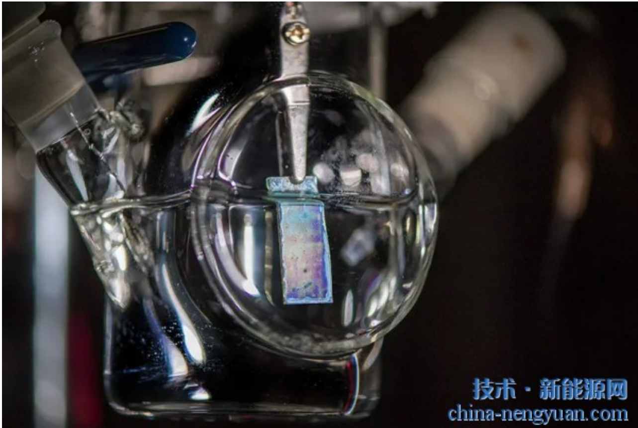
光电极通过分解水来产生氢气。照片：丹尼斯·施罗德，NREL
